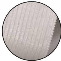
spalmatura della colla a "pettine" "striped" glue application
