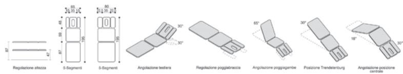
Lettino a cinque segmenti regolabile elettricamente in altezza da cm. 45 a cm. 90 mediante comando a pedale. Testa regolabile da +60° a -20° mediante pistone a gas con appoggia braccia regolabili e foro per la respirazione completo di tappo. Il busto e la pedaliera sono regolabili in più posizioni mediante pistone a gas. Può assumere la posizione Trendelenburg. Il piano è imbottito e rivestito in similpelle lavabile, antibatterico/antiacaro ed ignifuga classe 1/IM. Portata massima 150 kg.
