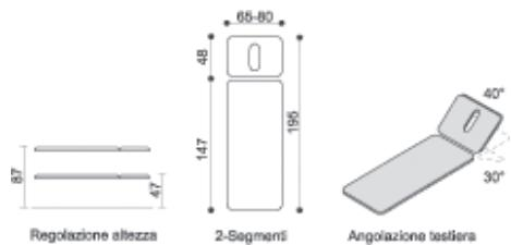
Lettino a due segmenti regolabile elettricamente in altezza da cm. 45 a cm. 90 mediante comando a pedale. Testa regolabile da +60° a -20° mediante pistone a gas. Foro per la respirazione completo di tappo. Il piano è imbottito e rivestito in similpelle lavabile, antibatterico/antiacaro ed ignifuga classe 1IM. Portata massima 150 kg.
