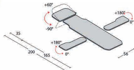
Lettino a quattro sezioni ad altezza fissa, per rieducazione posturale e massaggi. Il lettino è dotato di pediera regolabile mediante molla a gas e appoggia braccia laterali ruotabili e scorrevoli lungo tutto il piano. Il lettino è inoltre predisposto per l'applicazione dell'asta di sostegno per le caviglie regolabile in altezza e completo di corda e cavigliera. Grazie alla sua struttura questo lettino permette il passaggio del sollevatore e una portata di 180 kg.
